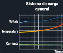
El cargador rápido de Makita se comunica con el chip incorporado de la batería durante todo el proceso de carga para optimizar la vida útil de la batería controlando activamente la corriente, el voltaje y la temperatura.
